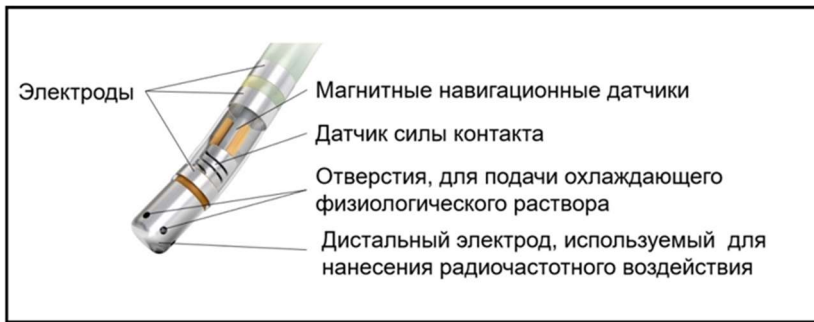
Рис. 1.17. Дистальное окончание радиочастотного навигационного катетера с датчиком силы контакта. Из Lin T. Arrhythmia & Electrophysiology Review 2013;3(1):44-7
